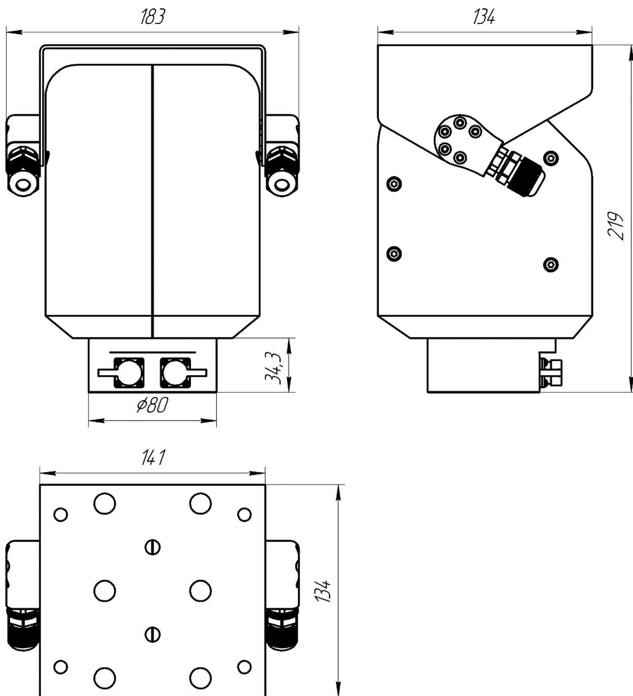
Рисунок А1 – Габаритные размеры опорно-поворотного устройства
