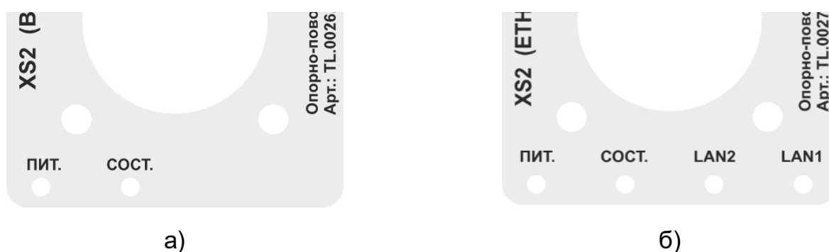
Рисунок 2 – Индикаторные светодиоды: а) TL.0026; б) TL.0027
