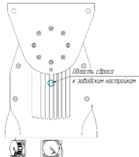
Рисунок 11 - Место сброса к заводским настройкам
