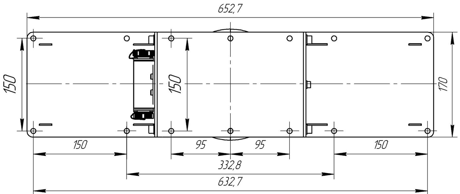
Рисунок А4 – Присоединительные размеры кронштейна полезной нагрузки
