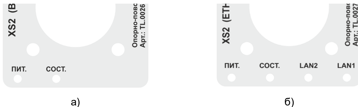
Рисунок 2 – Индикаторные светодиоды: а) TL.0026; б) TL.0027
