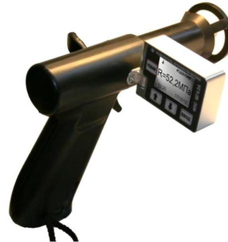
Электронный измеритель прочности бетона «ИПС-МГ4.04»
