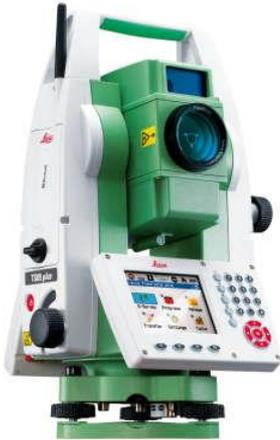
Тахеометр " Leica FlexLine TS09 plus 1" R500"
