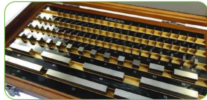
Концевые меры длины производства Mitutoyo (Япония) – это высокоточные измерительные эталоны в форме параллелепипедов из высококачественной стали или керамики, которые применяются для калибровки и поверки координатно-измерительных машин (КИМ), а также станков
