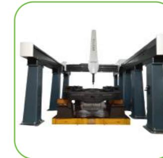
Крупногабаритные КИМ в мостовом исполнении позволяют контролировать тяжелые детали большого размера, которые невозможно уместить в измерительных объемах портальных машин и при этом, благодаря своей достаточно жесткой конструкции, обеспечивают непревзойденную точность системы даже для требовательных задач.
