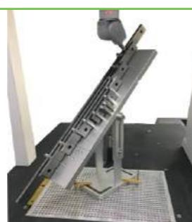
Универсальный фиксирующий стенд для концевых мер длины. Надежные фиксаторы с симметричным распределением по поверхности стенда. Гарантированное отсутствие эффекта прогиба и равномерное пятно контакта с КМД в местах фиксации. Диапазон длин КМД от 10 до 1000 мм; Диапазон угловой настройки 0-360°; Одновременная фиксация до 6 штук
