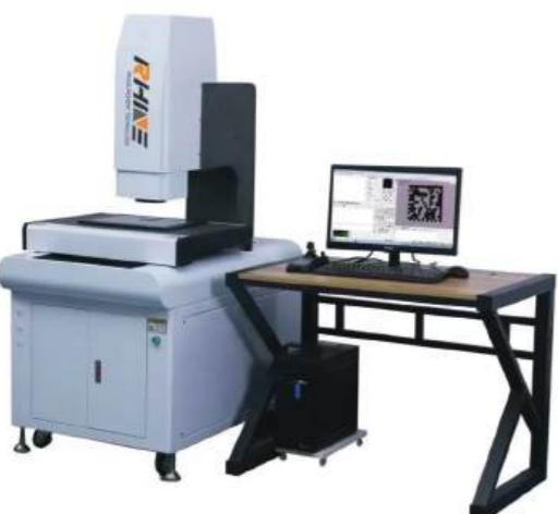
**Измерительный объем:** 300x200x200 до 500x400x200 мм
