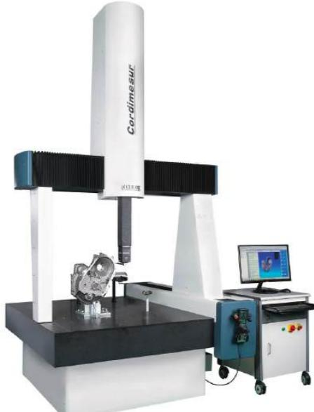
Портальные координатно-измерительные машины являются наиболее универсальным средством измерения для любой лаборатории или термостабильного помещения вблизи производства.
