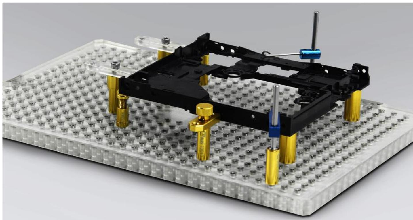
Процесс контроля на видео-измерительных машинах почти всегда подразумевает наличие деталей разной формы и материалов. Некоторые из них даже не имеют эффективной базовой плоскости, которую можно было бы использовать для правильного расположения на рабочем столе машины.
