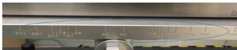
Возможность одновременного расположения до 6 КМД различной длины от 10 до 1000 мм.
