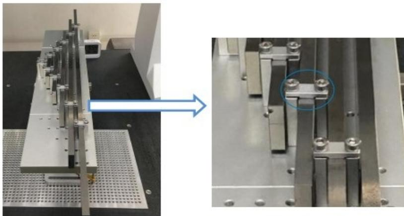
Наличие специальной шкалы с маркировочными точками для быстрого определения местоположения фиксаторов для концевых мер различных размеров:
